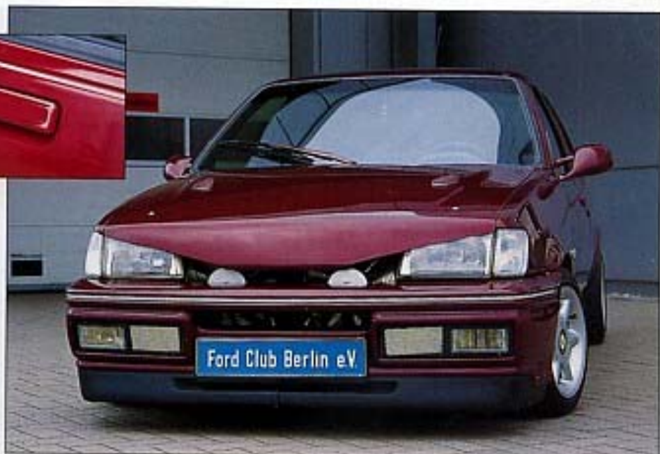
Vorne ist eine Golf-3-GT-Lippe verbaut
